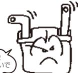
●バッテリーの端子に直接電気機器を接続しないでください。配線が焼損し、車両火災の原因となります。
