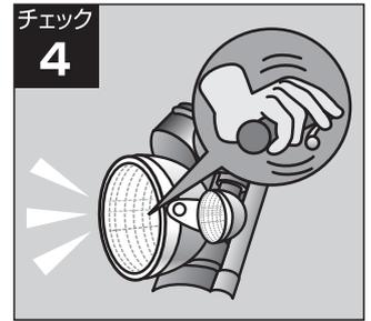
エンジンの回転数によってヘッドランプの明るさが変化しないか(バッテリー点灯方式の場合)
