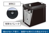
補水が全く不要で、酸霧や水素ガスの発生が少なく 酸素ガスをマイナス極板で吸収するパッテリーです。 万一、過充電などが発生した場合はパッテリー内部の ガスを放出する構造となっています。
